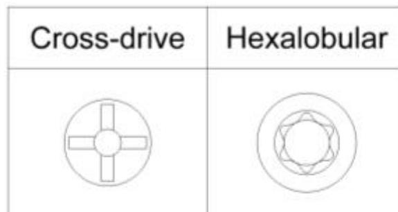
**Abbildung 2** – Typen der Schraubenköpfe: Kreuzschlitz (*cross-drive*); Innensechsrund (*hexalobular*).
